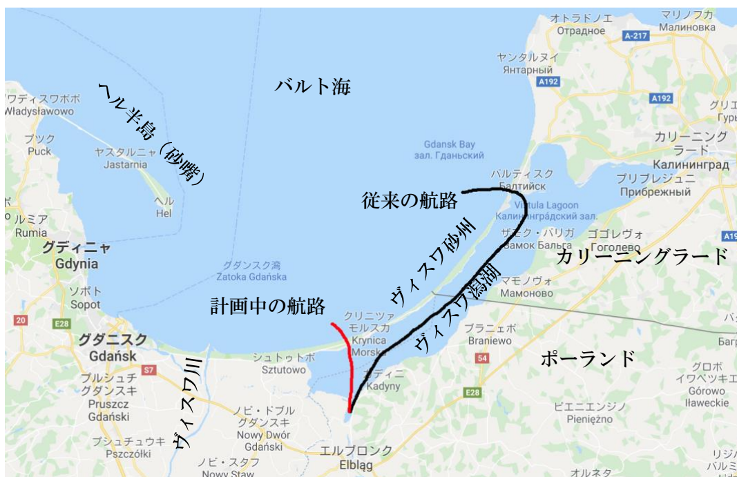
図5 ヴィスワ潟湖におけるエルブロンクまでの従来の航路とヴィスワ砂州横断運河完成後の航路
